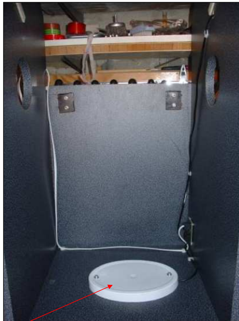
Kompletní instalace kabeláže (bílý kabel je k ovládacímu panelu, černé jsou k čidlům)
