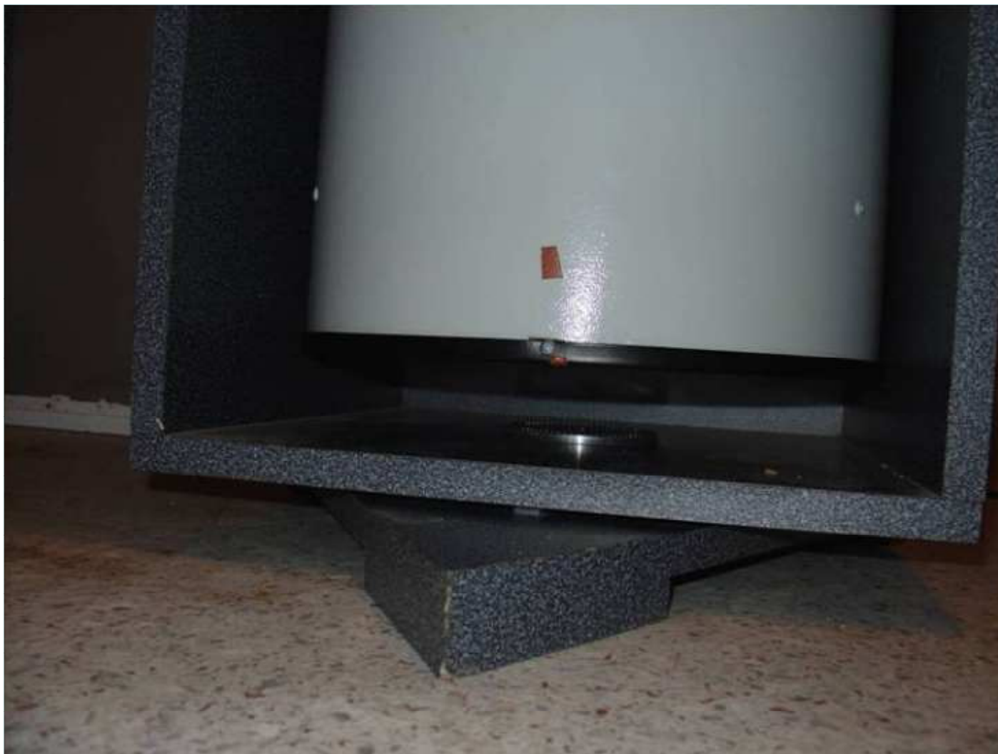
Znázornění volného prostoru mezi tubusem a azimutálním čidlem
