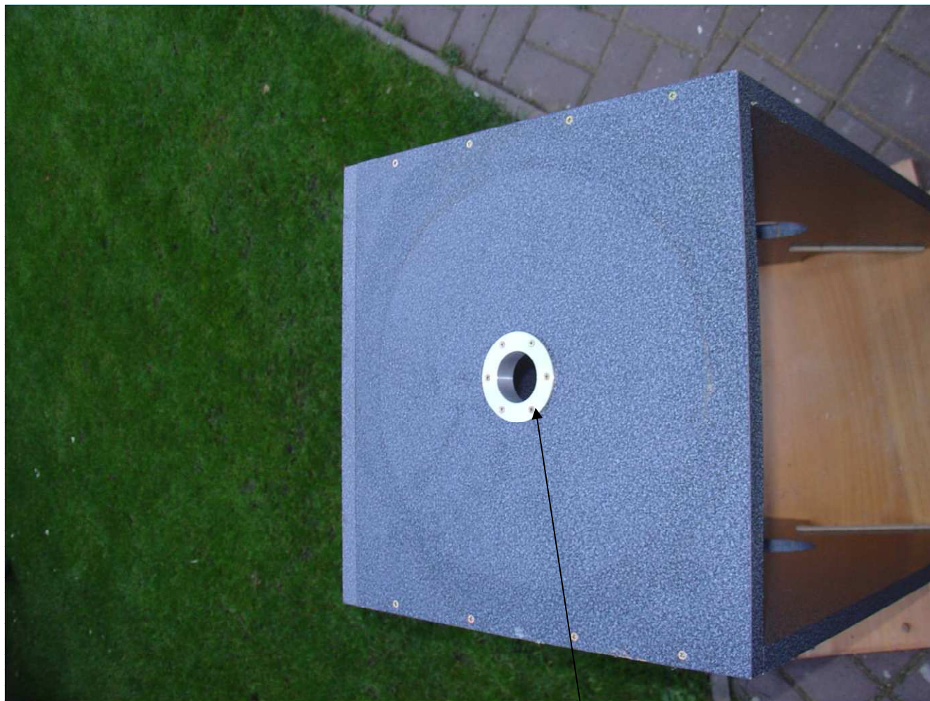
Detail zamontovaného pouzdra do těla „bedýnky“
