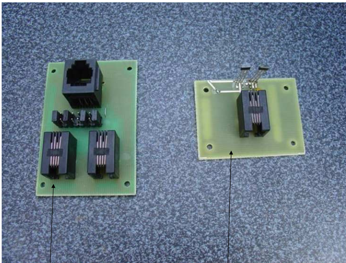
Deska pro propojení vertikálního a azimutálního snímače
